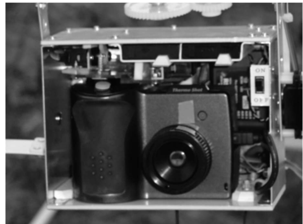
図.6 サーモグラフィーの搭載状況
