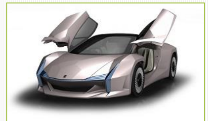
セルロースナノファイバーを用いた各種部品を搭載した軽量化自動車「Nano Cellulose Vehicle (NCV)」 出典：環境省
