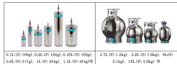
Fig. 9 小型のステンレス容器及びキャニスター容器的例
