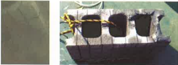
(a) コンクリートブロック(基本型) の着底状況と引き上げ後の状況 (約15cmのめり込み)
