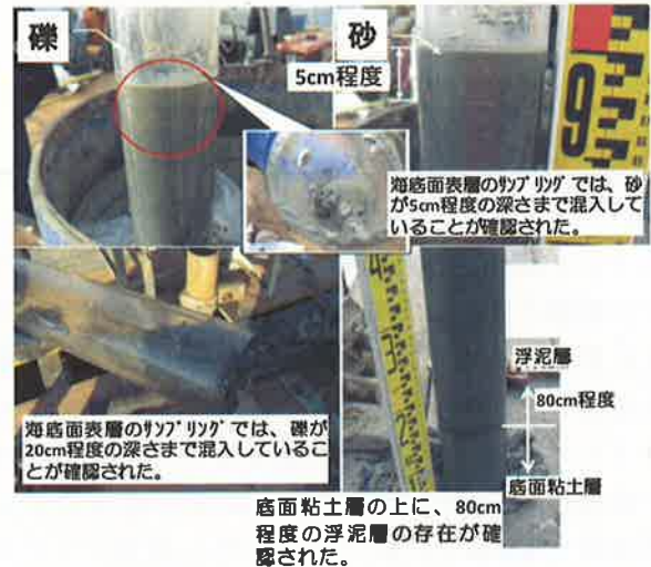
写真2 砂・礫のめり込み状況と浮泥層の存在の確認
