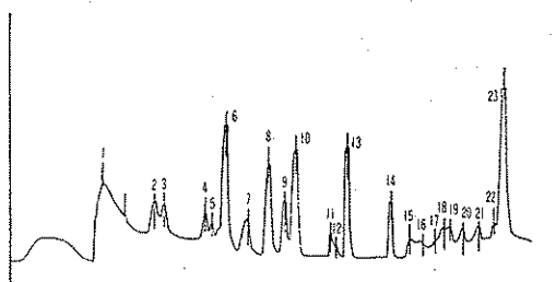
図5 下水道処理場曝気槽から発生する臭気のクロマトグラム
