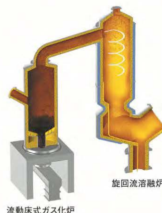
流動床式ガス化溶融炉
